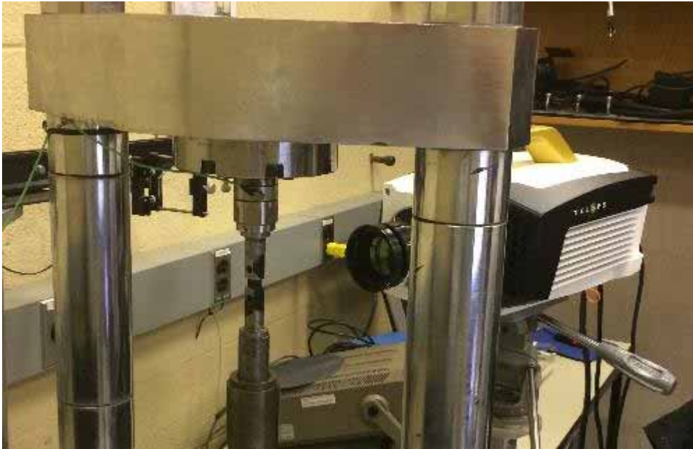
Pruebas de Fractura en Aluminio a 3350 fps
