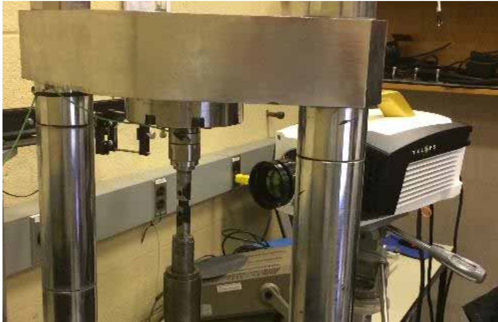
Pruebas de Fractura en Aluminio a 3350 fps
